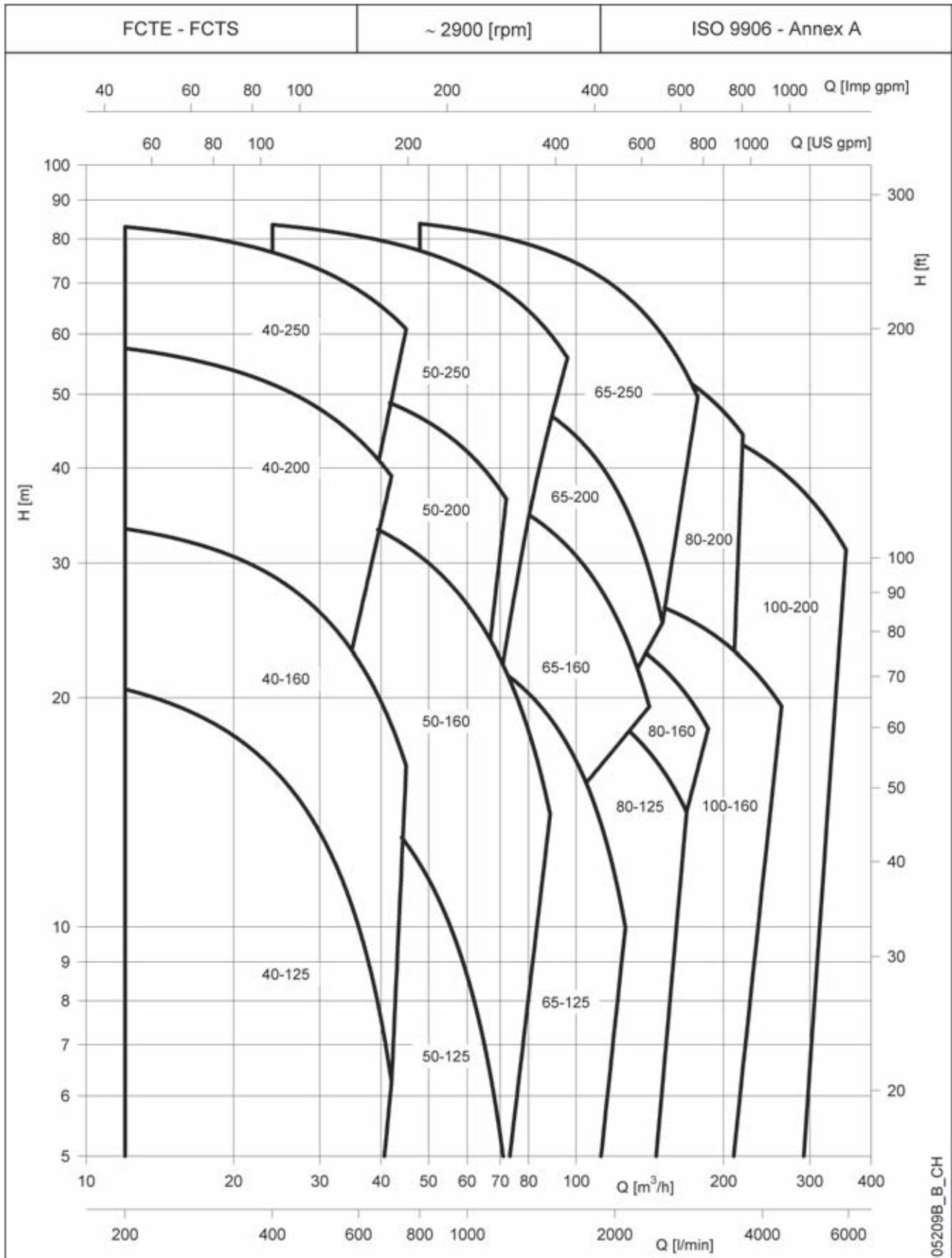
Die angegebenen Leistungen gelten für Fördermedien mit einer Dichte von  $\rho = 1,0 \text{ kg/dm}^3$  und einer kinematischen Viskosität von  $\nu = 1 \text{ mm}^2/\text{sec}$ .
