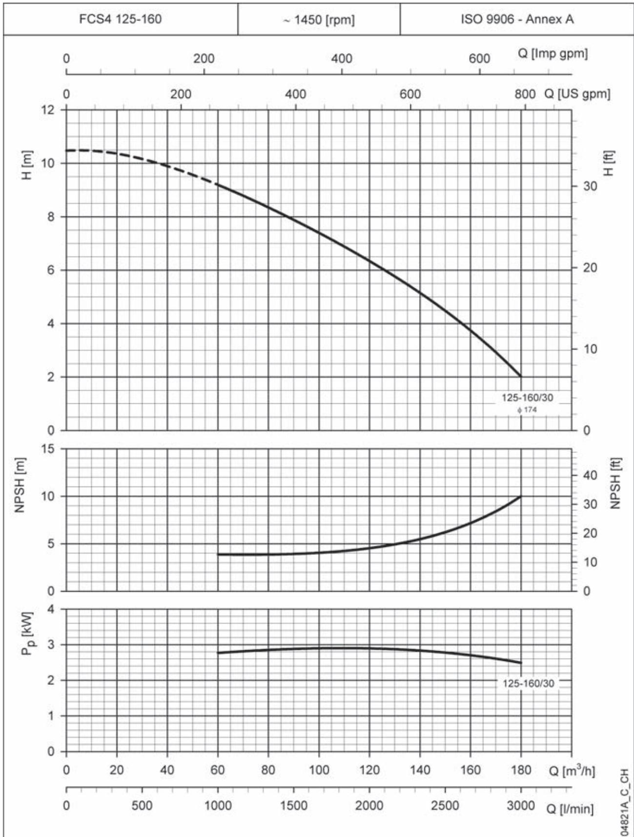
Die angegebenen NPSH-Werte sind Laborwerte. Für die Praxis ist es empfehlenswert, die Werte um 0,5 m zu erhöhen.
