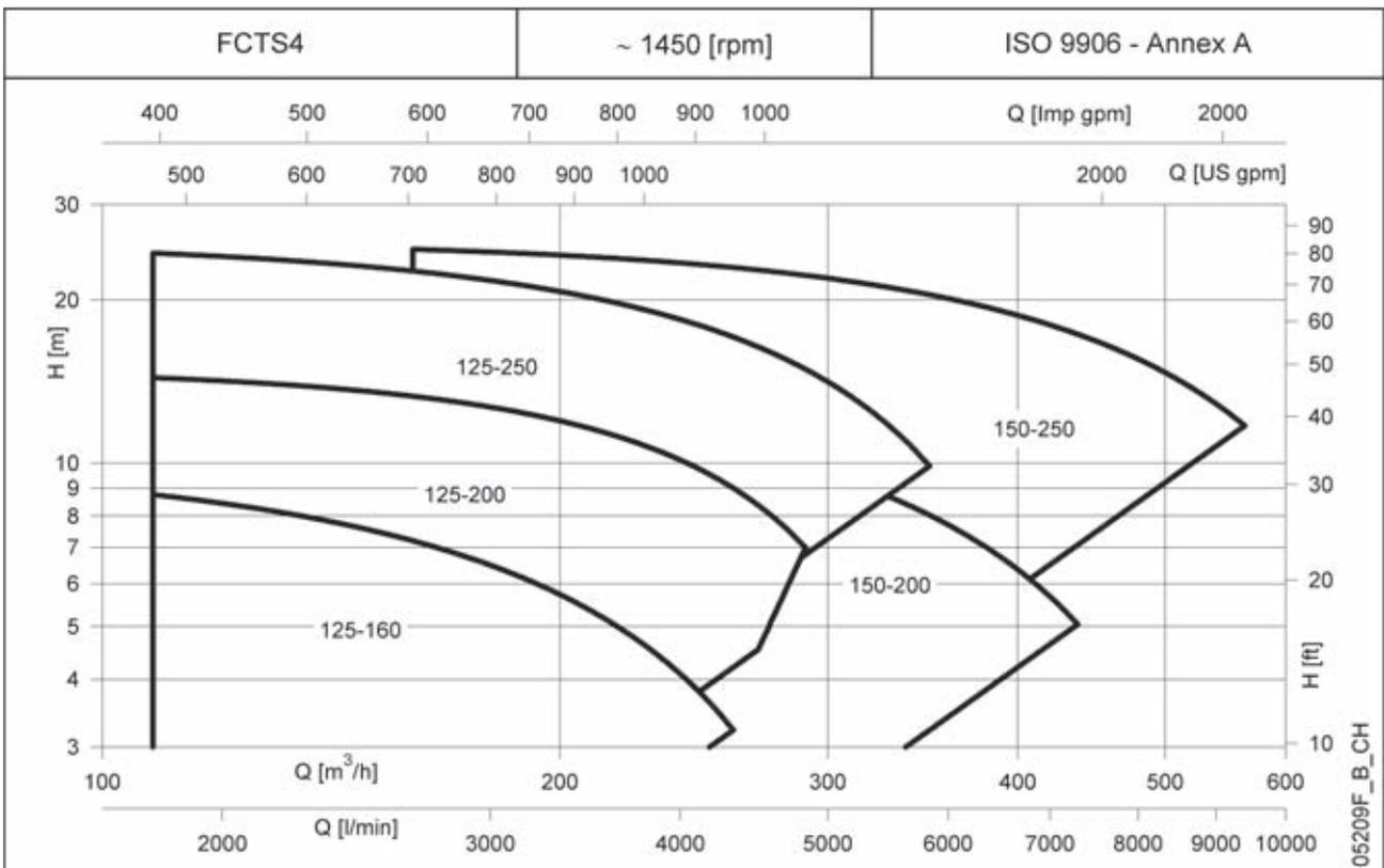
Die angegebenen Leistungen gelten für Fördermedien mit einer Dichte von  $\rho = 1,0 \text{ kg/dm}^3$  und einer kinematischen Viskosität von  $\nu = 1 \text{ mm}^2/\text{sec}$ .
