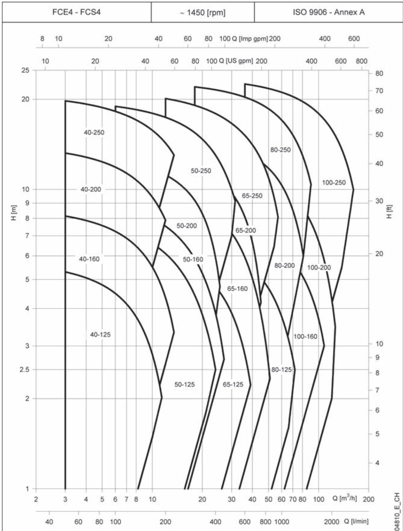
Die angegebenen Leistungen gelten für Fördermedien mit einer Dichte von  $\rho = 1 \text{ kg/dm}^3$  und einer kinematischen Viskosität von  $\nu = 1 \text{ mm}^2/\text{s}$ .
